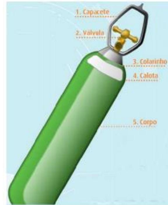
Não devem ser elevados com cabo de aço ou eletroímã. Somente devem ser movimentados em posição vertical, com as válvulas fechadas e o capacete de proteção devidamente colocado.
