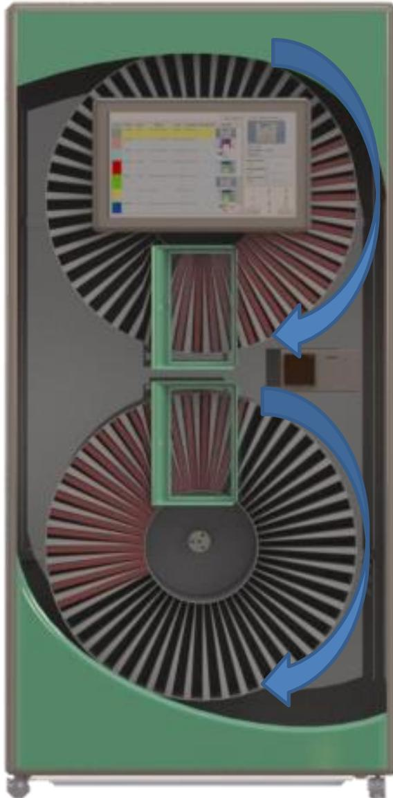
O sistema da STENTBOX será baseado em Dois magazines comportando cerca de 50 stents cada. Ao selecionar o stent através da interface touch um motor irá girar o magazine até que o slot contendo o stent selecionado se posicione frente a porta. Uma vez posicionado a porta se abre, permitindo a retirada do stent. Esse design minimiza o uso de partes móveis garantindo maior confiabilidade e robustez ao sistema.
