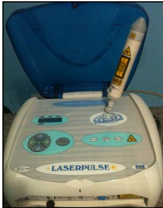
Figura 3: Equipamento Laserpulse® de baixa potência – LASER semiconductor AlGaInP - 660nm (IBRAMED, 2013).
